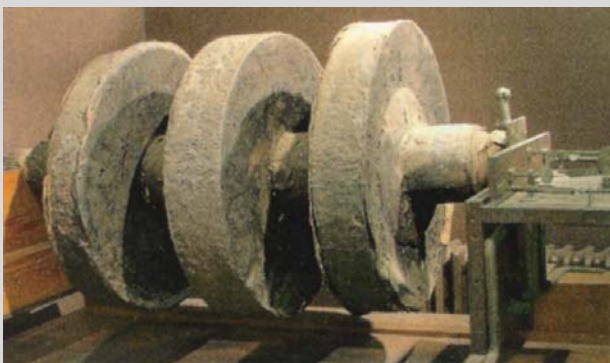
Μια γιγαντιαία σπείρα του Callan αποτελούμενη από 3 σπείρες με καλώδιο 10 μιλίων η κάθε μια. Το 1837 αυτή η κατασκευή παρήγαγε σπινθες μήκους 38 cm!!!
