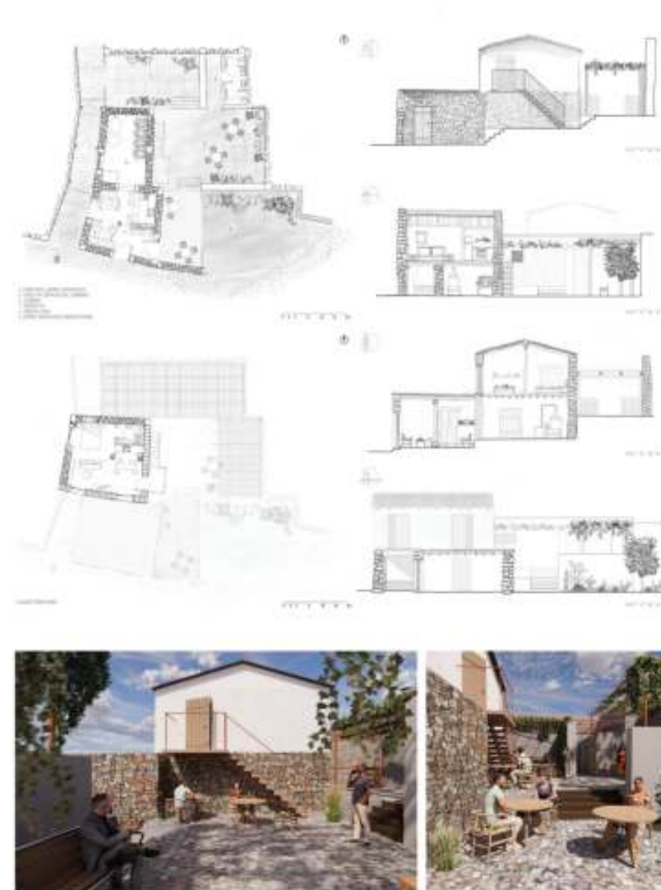
Αγίοι Βαβατσίνας. Επανάχρηση παραδοσιακής οικοδομής (κατόψεις, τομές, όψεις και φωτορεαλιστικά) / Agioi Vavatsinias. Revival of a vernacular dwelling (plans, sections, elevations and photorealistic images)
