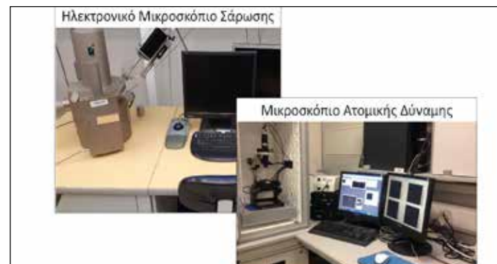
Ηλεκτρονικό Μικροσκόπιο Σάρωσης και Μικροσκόπιο Ατομικής Δύναμης του Τμήματος Μηχανικών Μηχανολογίας και Κατασκευαστικής του Πανεπιστημίου Κύπρου που χρησιμοποιούνται στην μελέτη μορφολογίας, χημικής σύστασης και ιδιοτήτων νανοϋλικών
