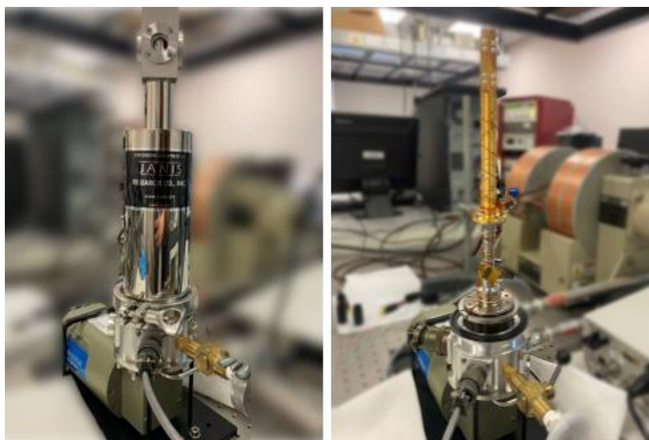
Εικόνα 8: Φωτογραφίες του κρυοστάτη που χρησιμοποιήθηκε στο εργαστήριο. Στην πρώτη (αριστερή) εικόνα φαίνεται ο εξωτερικός του εξοπλισμός, ενώ στην δεύτερη (δεξιά) φαίνεται ο εσωτερικός του εξοπλισμός
