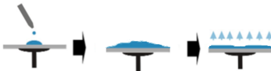
Εικόνα 3: Απεικόνιση διαδικασίας drop-casting για δημιουργία λεπτής ταινίας, στην εικόνα φαίνεται η ανομοιομορφία της ταινίας
